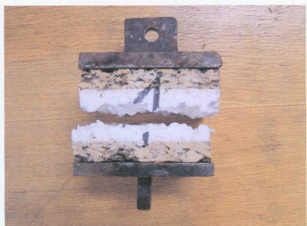
Obrázek 34: Zkouška pevnosti v tahu kolmo k rovině desky - výsledek zkoušky (typ IV)
