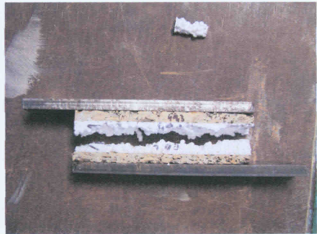
Obrázek 26: Zkouška pevnosti ve smyku - výsledek zkoušky, typ IV
