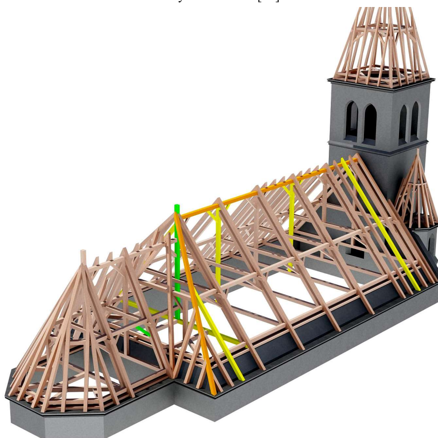
Obr. 17: Zobrazení poškození krovové konstrukce ve 3D modelu [13].
