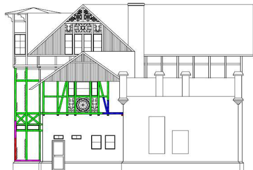
Obr. 9: Grafické zaznamenání výsledku průzkumu dřevěných fasádních prvků západní strany unikátní hrázděné stavby veslařského klubu v Brně – Jundrově, kresleno v měřítku výtah z dokumentace [7].
