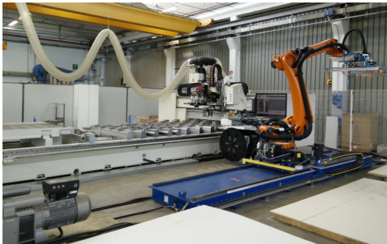
Obr. 3: Pojízdný robot KUKA umístěný ze zadní strany CNC stroje Accord 40 FX (SCM) [1]
