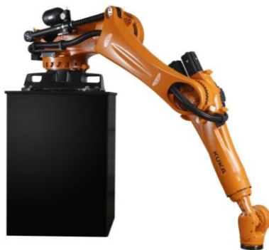
Obr. 2: Robot pro zakládání a odebrání obrobků [1]
