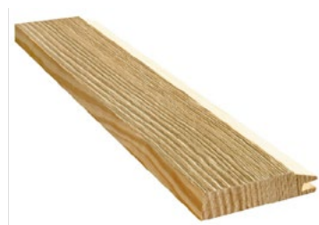
Obr. 6: Efekt podélného drásání povrchu
