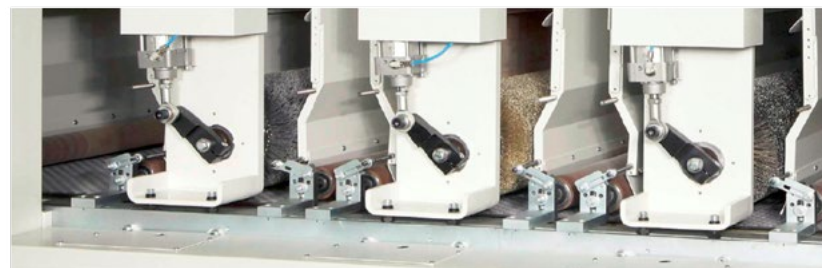
Obr. 5: Jednotky pro podélné drásání povrchu
