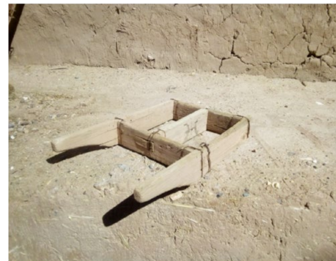
Obr. 6: Forma pro výrobu nepálených hliněných cihel
