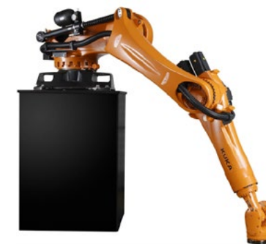
Obr. 2: Robot pro zakládání a odebírání obrobků
