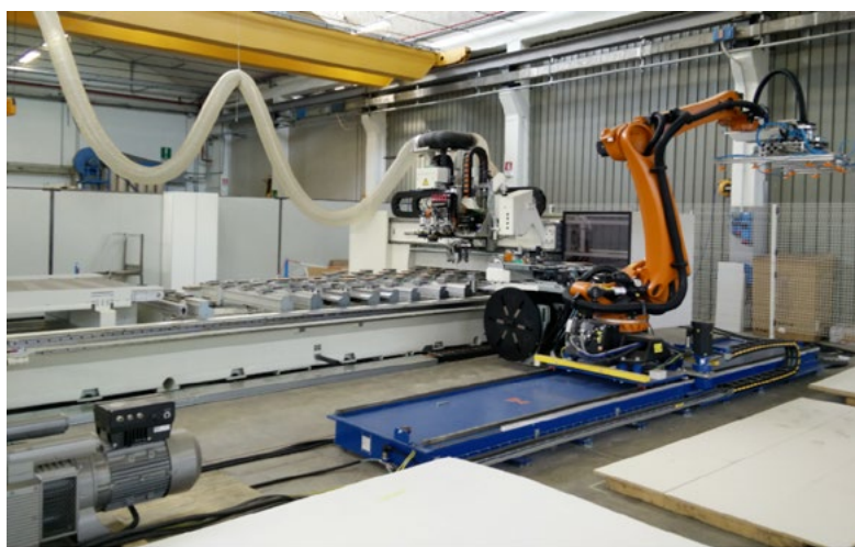
Obr. 3: Pojízdný robot KUKA umístěný ze zadní strany CNC stroje Accord 40 FX (SCM)
