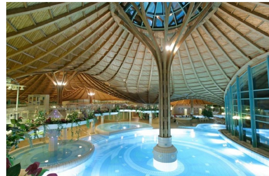
Obr. 16: Žebrová skořepina – zastřešení solánkové lázně, 1987, Bad Dürreheim, Německo
