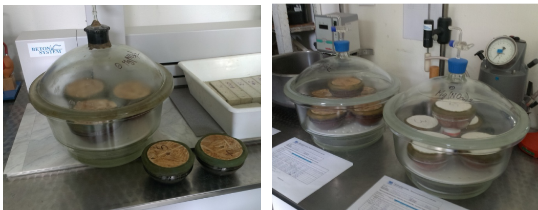
Obr. 3 Zkušební skleněné mísy s přírubou a se vzorky s nátěrem latexu a perforací OSB (foto: autor)
